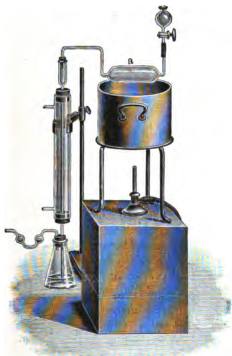
Fig. 98. — Appareil pour le dosage de l'acide borique.
